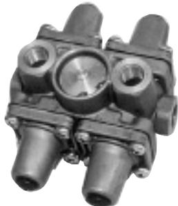
No sistema pneumático de freios da linha pesada, quando o motorista reclama que a pressão de ar baixa rapidamente com o uso do freio de serviço e, após os devidos testes, nota-se que as válvulas e tubulações do sistema não apresentam vazamentos ou defeitos, deve-se checar se o veículo possui equipamento de “Rodo-ar” (utilizado para manter a pressão ideal nos pneus) e verificar em que parte do sistema de freios está ligada a alimentação de ar do equipamento.
