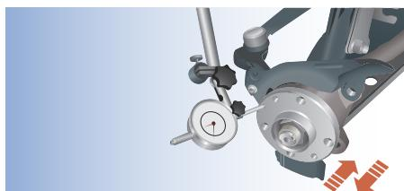
A folga axial nos rolamentos das rodas não deve exceder 0,054 mm. Se ultrapassar, substitua os rolamentos e faça os ajustes necessários.
