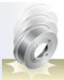
Choques mecânicos como marteladas ou quedas podem causar ovalização dos tambores, provocando trepidação no pedal de freio durante a frenagem.
