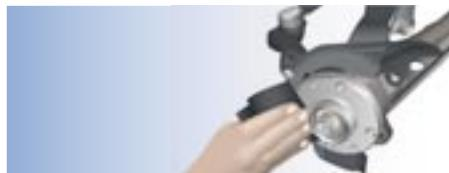
Limpe as faces de contato entre o disco de freno e o cubo.
